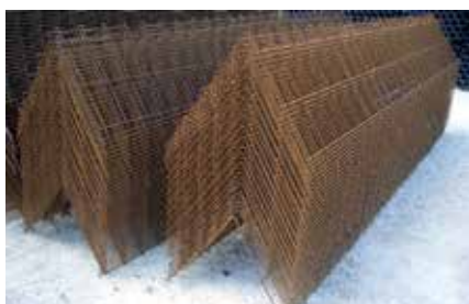
Stahlkörper aus Baustahlmatten
